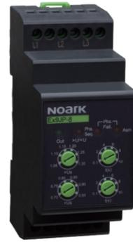
电压保护继电器适用于交流50Hz，三相三线制380V、三相四线制220V的电路中，作为过电压保护、欠电压保护、断相保护、相序保护、三相不平衡保护、PTC温度保护、负载端保护控制用，可用于电力控制系统、空调系统、电机保护等。
